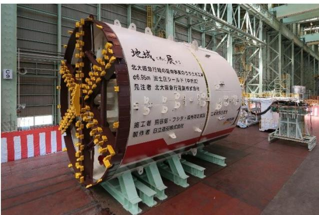
【2号機上り線（北行き）用シールド掘進機】
