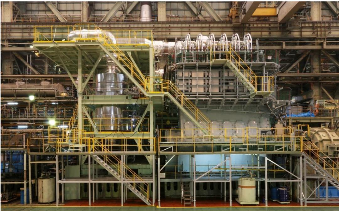
完成した SCR システム搭載型船用エンジン
