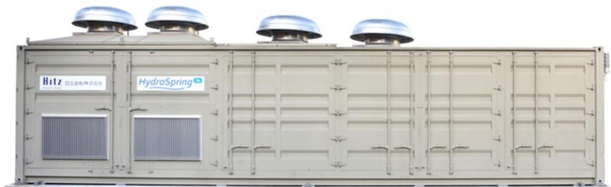
「HYDROSPRING®」は、電解槽や整流器、純水製造装置など水素発生（水電解）に必要な装置が全てコンテナ内に納められており、水と電気を供給すればオンサイト、オンタイムで水素を発生させることが可能です。当社製造工場ではコンテナパッケージ化することにより、そのまま設置現場へ輸送できるほか、設置現場での建屋建設不要、設置面積の低減などのコスト低減効果があります。40 フィートコンテナパッケージでは、MW 級の電力で水電解することにより 200N m<sup>3</sup>/h 超の水素を発生させることが可能であり、PEM 型として国内最大級となります※。
