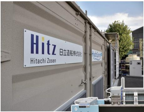
再生可能エネルギー用にMW級(200Nm<sup>3</sup>/h超)のHYDROSPRING®がラインナップに加わりました。日立造船の持つ電解技術とフィルターブレスの技術を融合させることにより、開発に成功しました。コンテナに内蔵した屋外仕様のため、現地での設置が容易で、新たに建屋を建造する必要もありません。
